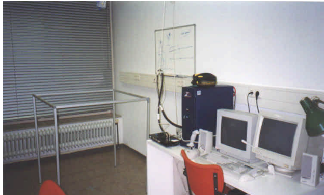
Figuur 6: VR behandel opstelling. Linksachter is de railing te zien waarbinnen de patiënt plaats neemt. Rechts zijn de beeldschermen waarop de therapeut de beweging van de patiënt in de virtuele wereld kan volgen.
